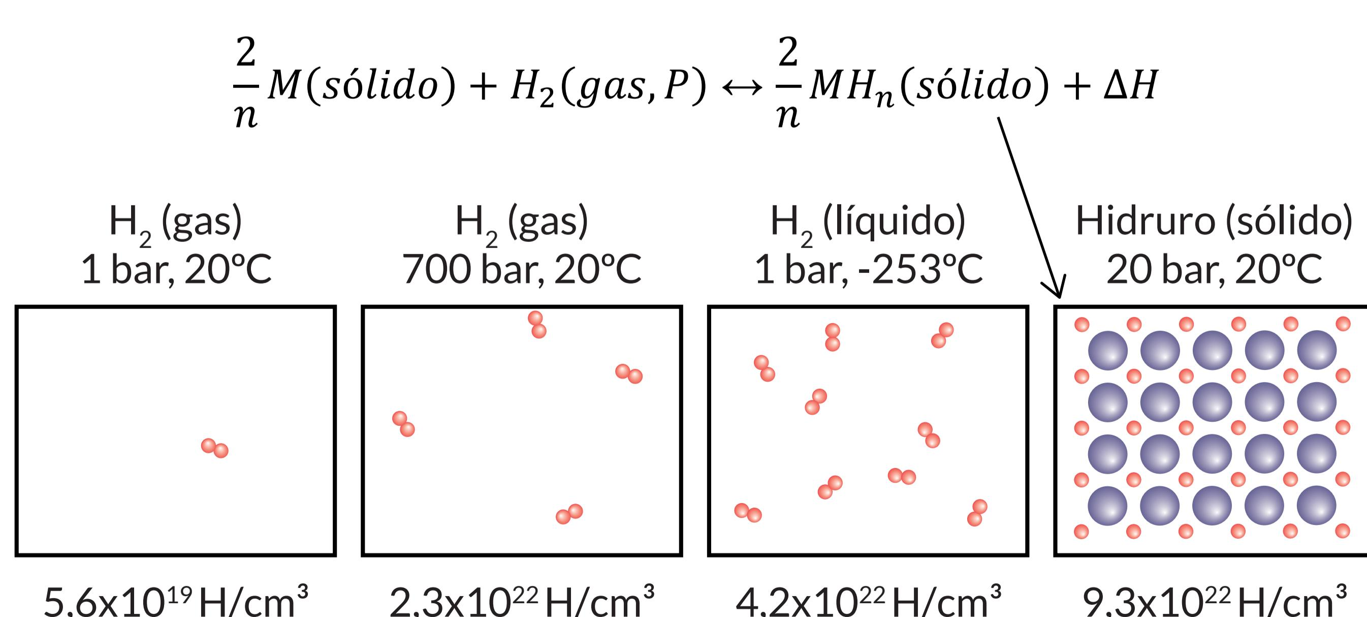
El modelo se centra en la absorción de hidrógeno presurizado, describiendo la transformación del metal base en su aleación hidrurada mediante la ecuación de Avrami, y representando la transferencia de calor con la ecuación de Fourier y la ley de enfriamiento de Newton.
