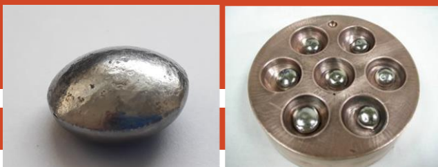
Fig.1 Foto tomada del crisol y de un botón de aleación
