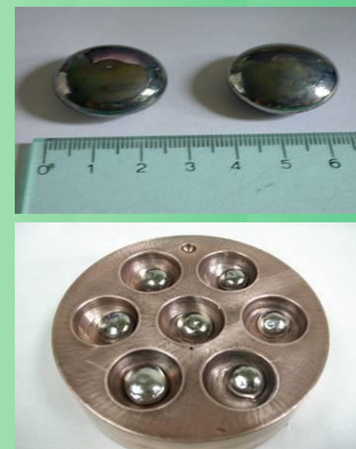
Figura 1. Crisol de cobre y las aleaciones obtenidas por fundición en el horno de arco eléctrico
